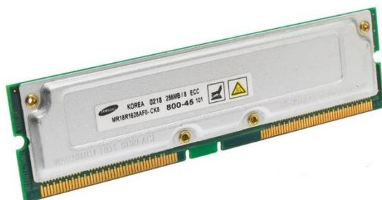
**RIMM**, acrónimo de “*Rambus In-line Memory Module*” designa a los módulos que utilizan una tecnología denominada **RDRAM**, desarrollada por la empresa **Rambus**. Éste tipo de memorias funcionan con un régimen alto de frecuencia, mucho mayor a los **DIMM**, que van desde 133Mhz a 533Mhz, por este motivo es que poseían disipador. Poseen 184 pines y fueron populares a mediados de los años 90’, aunque su alto valor y el advenimiento de los módulos **DDR** hicieron que no fueran de
